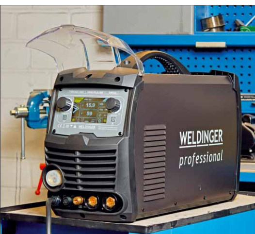
Display und Schalter werden durch eine Plexiglashaube geschützt
