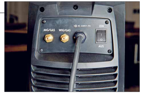
Auf der Rückseite befinden sich neben dem Hauptschalter auch die Gaszugänge für MIG/MAG- und WIG-Schweißen
