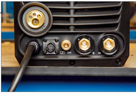
Schlauchpakete und Schweißkabel werden über Standard-Anschlüsse mit dem Gerät verbunden
