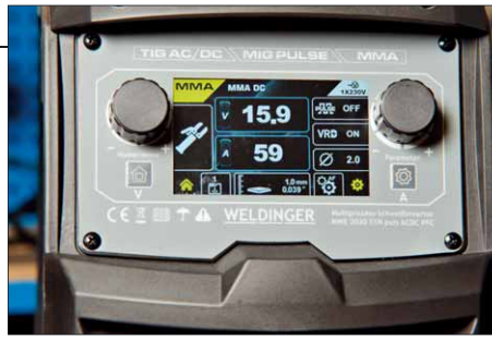
Über die Drehschalter neben dem Display können alle Schweißparameter eingestellt werden
