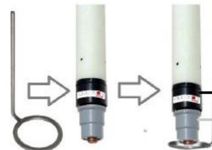
Opcja samodzielnego wykonania OHMIC simple option for making an ohmic element
