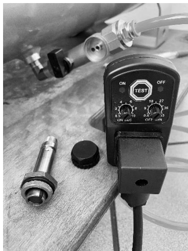
Abb.2: Demontierte Steuereinheit mit Ventileinsatz
