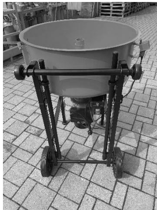
Abbildung unten: seitlich in die Aufnahmen eingesetzte Transportstangen bei stehendem Gerät.
