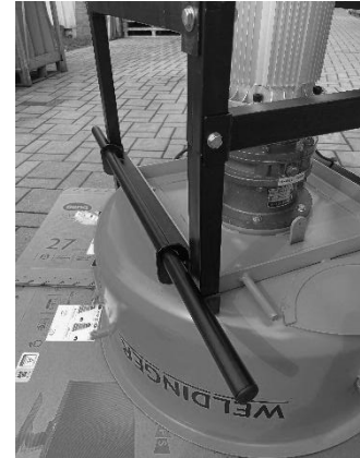
Abbildungen links und rechts: Ösen und beispielhafte Durchführung der Transportstange beim Aufbau.
