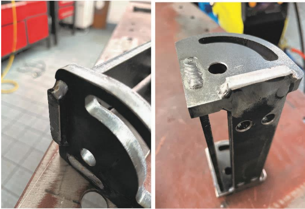
Ansicht Werkstücke 5, 6 und 7 nach den Schweißarbeiten.
