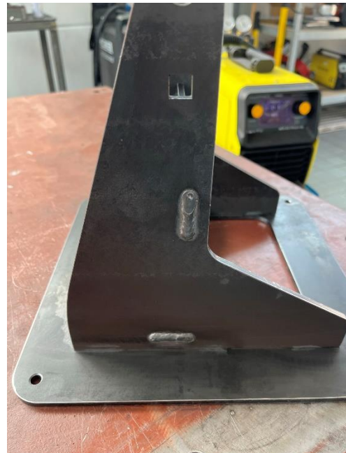
Ansicht Werkstücke 1, 2, 3 und 4 nach den Schweißarbeiten.
